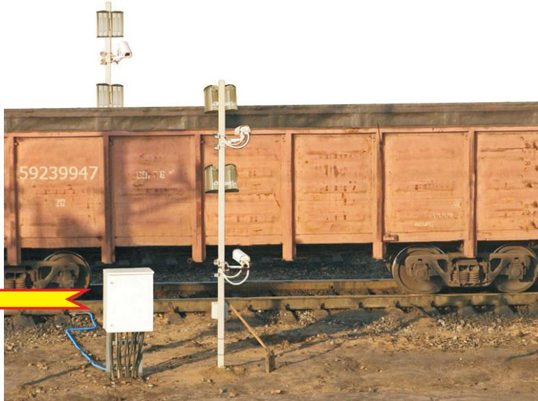
Пост считывания объединяет оборудование, устанавливаемое непосредственно у ЖД пути (напольное оборудование) и формирует зону контроля системы АСКИН
