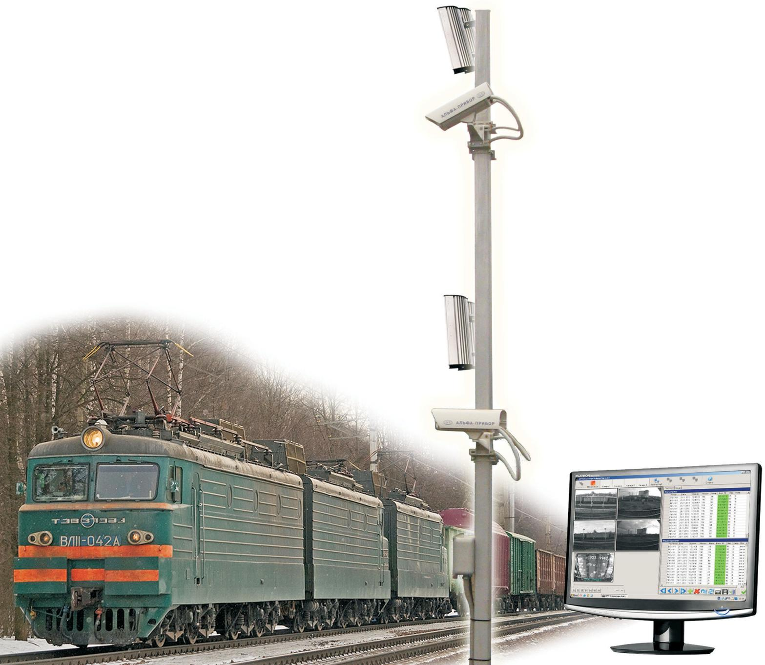
**АСКИН** обеспечивает автоматизацию технологических процессов по распознаванию и списыванию инвентарных номеров грузовых вагонов, а также по формированию справки о прошедшем составе.
